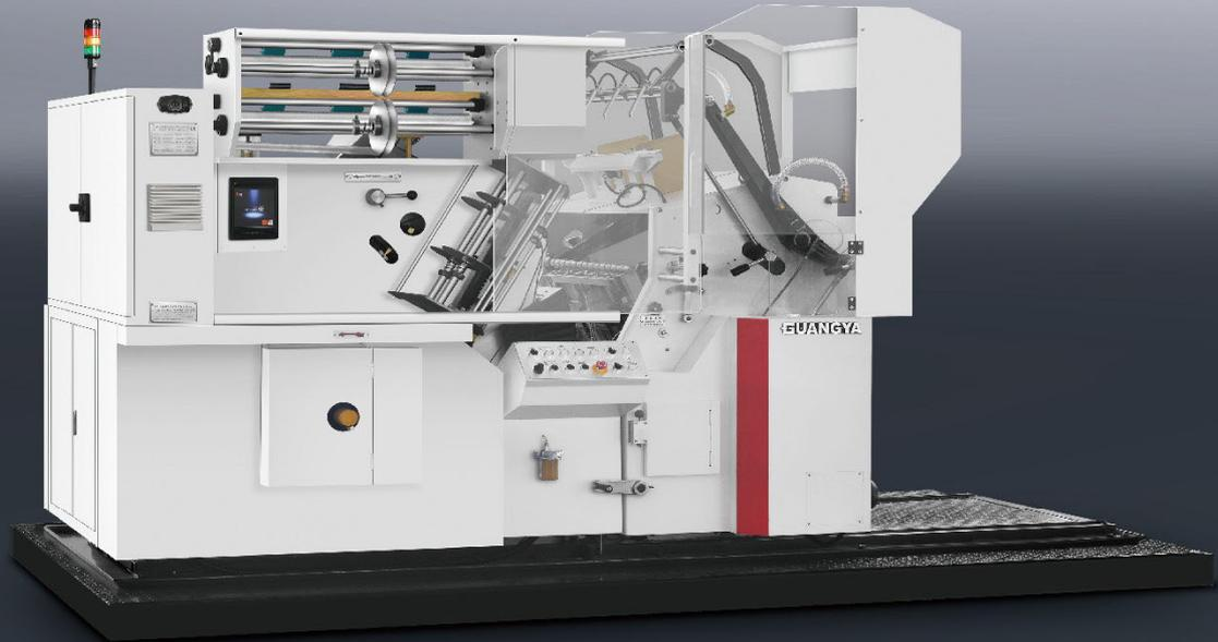
TL780立式自动烫印模切机是为了满足当今的烫印、模切、压凸、压痕工艺而设计的，用于纸张，亦可用于塑料薄膜。能自动完成输纸模切剥离收纸工作循环。
